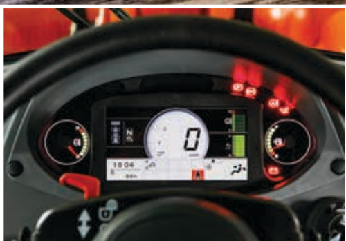
Le nouveau moniteur LCD affiche le statut et les paramètres de la machine.
