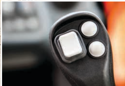
Le commutateur d'augmentation rapide de puissance accroît la puissance lorsque c'est nécessaire.
