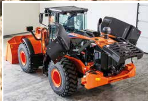
Accès aisé depuis le sol pour les entretiens.
