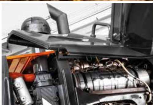
Le système SCR réduit les émissions.
