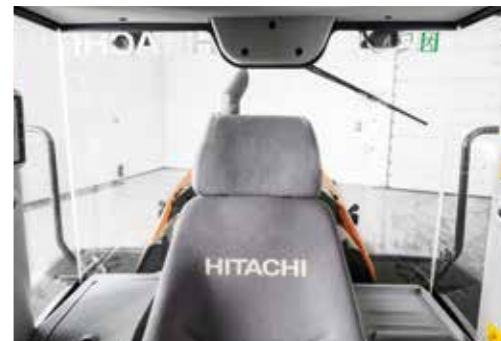
La visibilité à l'arrière a été améliorée par une modification de l'architecture de l'engin.
