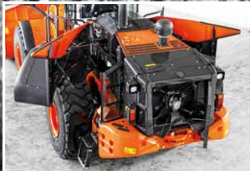
Les capots s'ouvrent complètement pour faciliter l'accès lors des opérations d'entretien.
