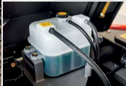
Le vase à expansion empêche la surchauffe des pièces du moteur.
