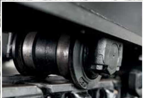
Le matériau renforcé utilisé dans la fabrication des galets améliore la résistance à l'usure.
