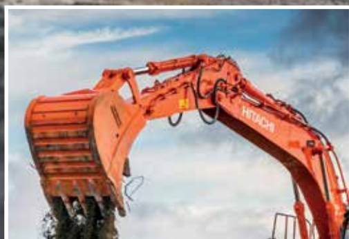
Flèche renforcée et équipement frontal.
