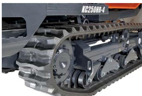
Le train de chenille du KC250-4 est équipé de galets à triple flasques. Huit d'entre eux sont montés sur un support oscillant, ils offrent une excellente stabilité sur les pentes et les terrains accidentés réduisant ainsi les risques de déchenillage. Les chaînes à pas court réduisent les vibrations, offrant ainsi un confort optimal à l'opérateur même à vitesse rapide.
